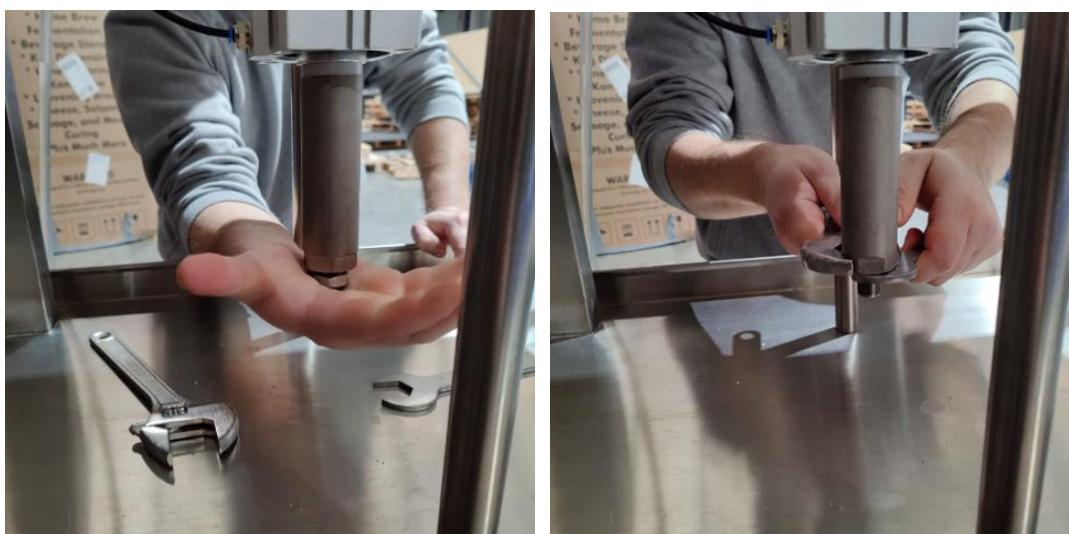
**2.6.6**-Une fois que la cartouche est bien en place, faites pivoter la butée de piston vers le haut jusqu'à ce qu'elle touche le bloc piston. Ensuite, serrez l'écrou de blocage. Enfin, serrez à nouveau avec les deux clés.
